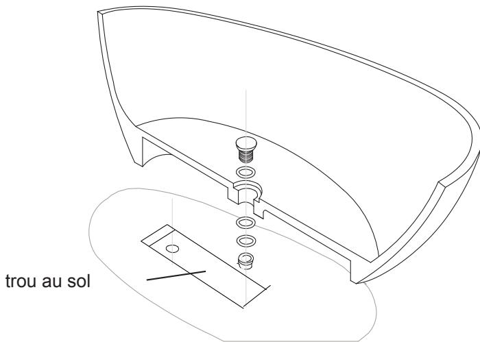
3. Alignez le joint de dilatation et appliquez du joint en silicone pour étanchéifier autour de la bonde.
