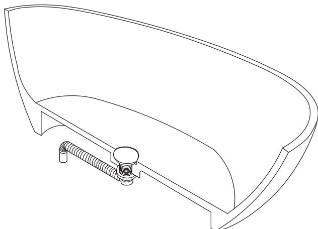
5. Rögzítse a kádat üvegcementtel a padlóhoz a szigetelés biztosítása érdekében. Fél óra elteltével töltön vizet a kádba, és az alsó leürítő nyíláson keresztül engedje le a vizet, hogy megbizonyosodjon arról, hogy minden csatlakozás vízzáró.
