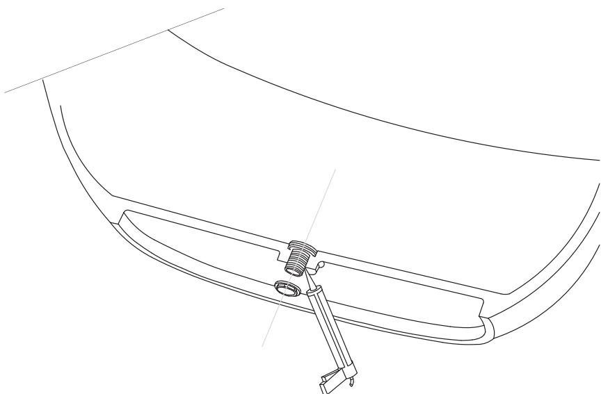
4. Instalați conducta instalației, apoi conectați-o la orificiul de scurgere în poziție dreaptă și stabilă.
