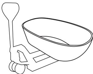
5. Așezați câteva scânduri dedesubt pentru a susține ferm partea inferioară, întoarceți și poziționați stabil cada pe lateral și apoi instalați rezervorul de drenare.
