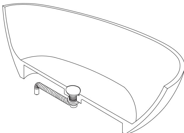
5. Befestigen Sie die Badewanne mit Glaszement auf dem Boden, um sicherzustellen, dass sie abgedichtet ist. Füllen Sie nach einer halben Stunde Wasser in die Badewanne und lassen Sie es ablaufen, um sicherzustellen, dass alle Fugen wasserdicht sind.
