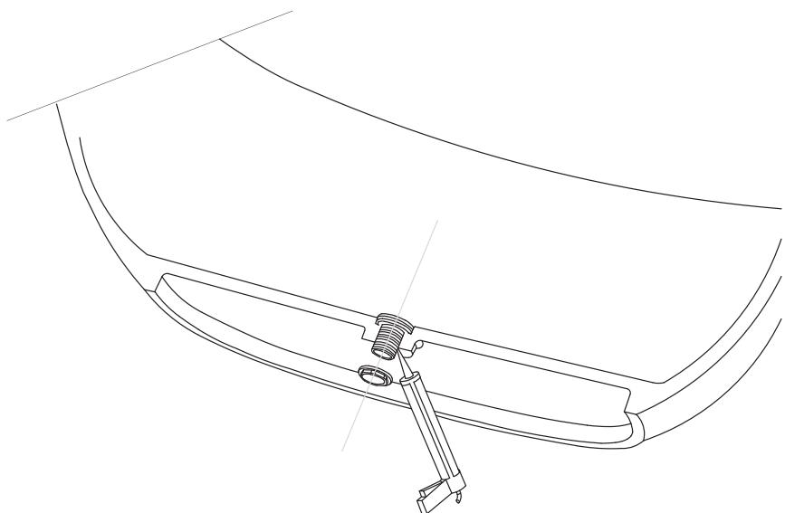
4. Installez le tuyau d'évacuation et raccordez-le au trou pour qu'il soit droit et stable.
